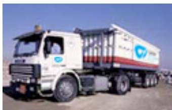
Figura 3.3.5.4.1 – plataforma de garrafas de H_2 gasoso.
